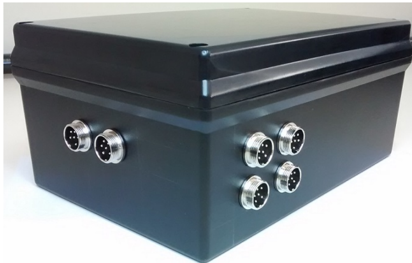
Figura 24 – Conectores já fixados na caixa.
